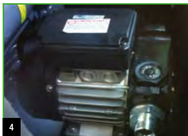
4. Automatic-manual fuel transfer pump / Bomba trasiego para combustible manual y automática / Pompe à main de transfert du combustible, pompe automatique du transfert du combustible.
