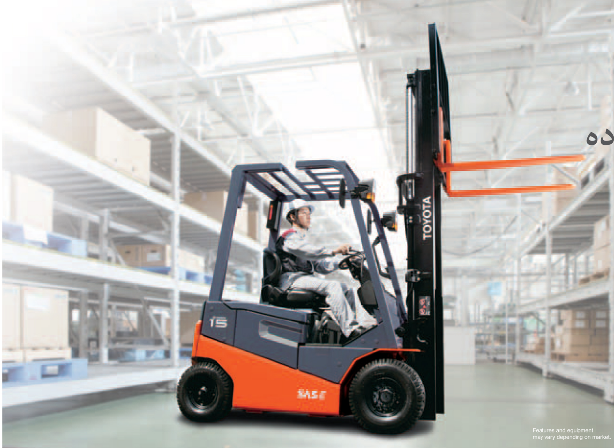
سری 8FB از بالا بودن اکسل عقب بهره می برد که نزدیکتر به مرکز ثقل دستگاه می باشد. به این ترتیب در زمان دور زدن، پایداری دستگاه حفظ می شود.
