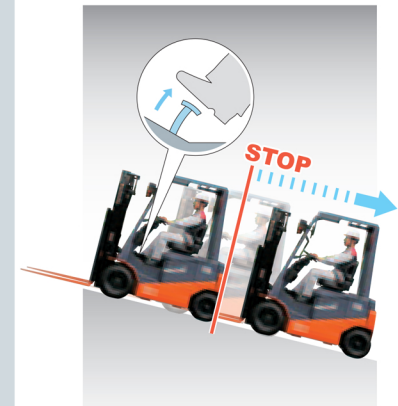
در زمان توقف در شیب، هنگامی که پدال ترمز یا گاز آزاد می شود، لیفتراک متوقف شده و با سرعت ثابتی شروع به حرکت می کند، این سیستم کاربری آسان دستگاه را در شیبها ممکن می سازد.
